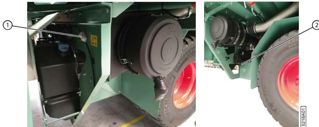
Fig. 176: Localisation des filtres AdBlue
