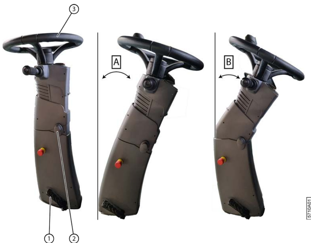
Fig. 90: Incliner le volant
