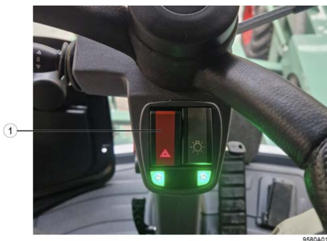
Fig. 72: Activer les feux de détresse
