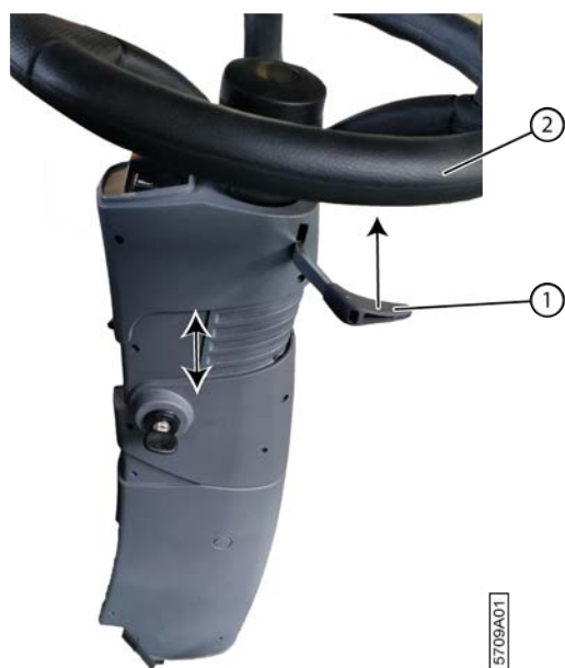
Fig. 89: Régler la hauteur du volant
