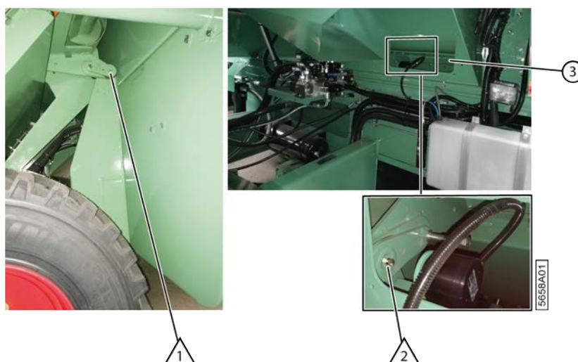
Fig. 148: Lubrifier les points charnières de l'arracheur
