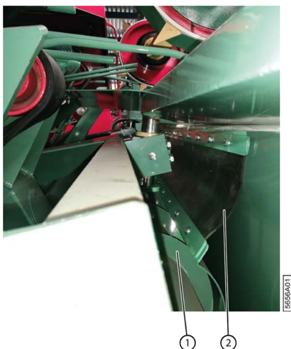
Fig. 146: Vérifier l'état du rabat en caoutchouc sur le vérin
