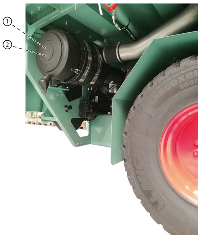
Fig. 173: Élément principal et élément de sécurité du filtre à air
