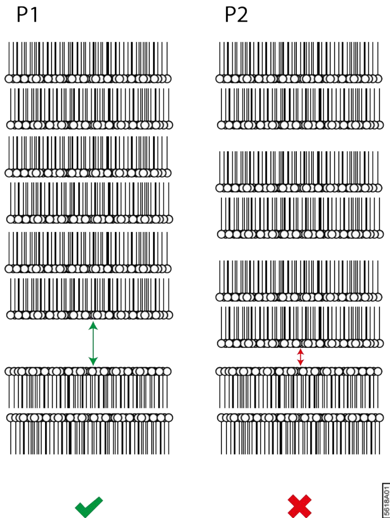
Fig. 95: Déplacer les tables par rapport à la machine
