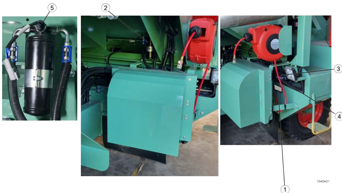
Fig. 118: Emplacement des éléments de l'air conditionné
