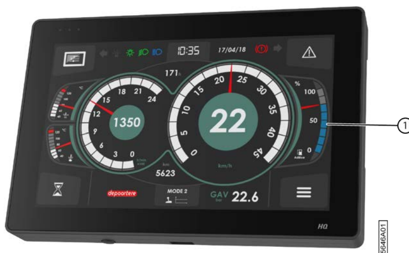
Fig. 112: Affichage du niveau d'AdBlue sur la fenêtre du mode Route
