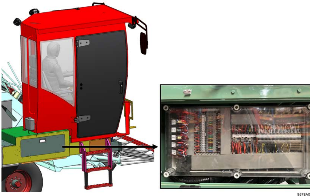
Fig. 32: Emplacement de l'armoire électrique
