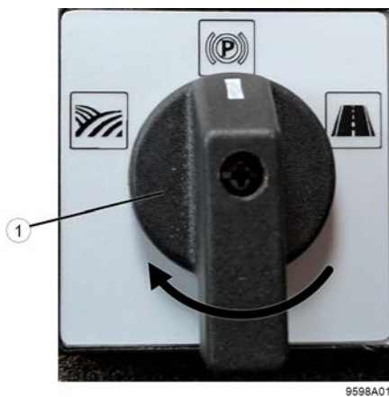
Fig. 79: Mettre l'interrupteur en mode Route
