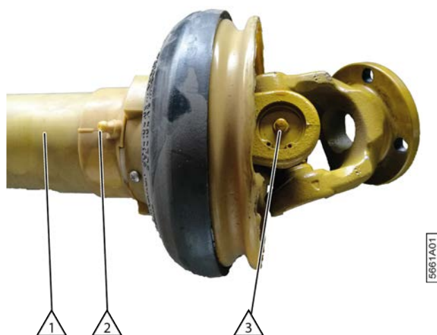
Fig. 153: Lubrifier le cardan
