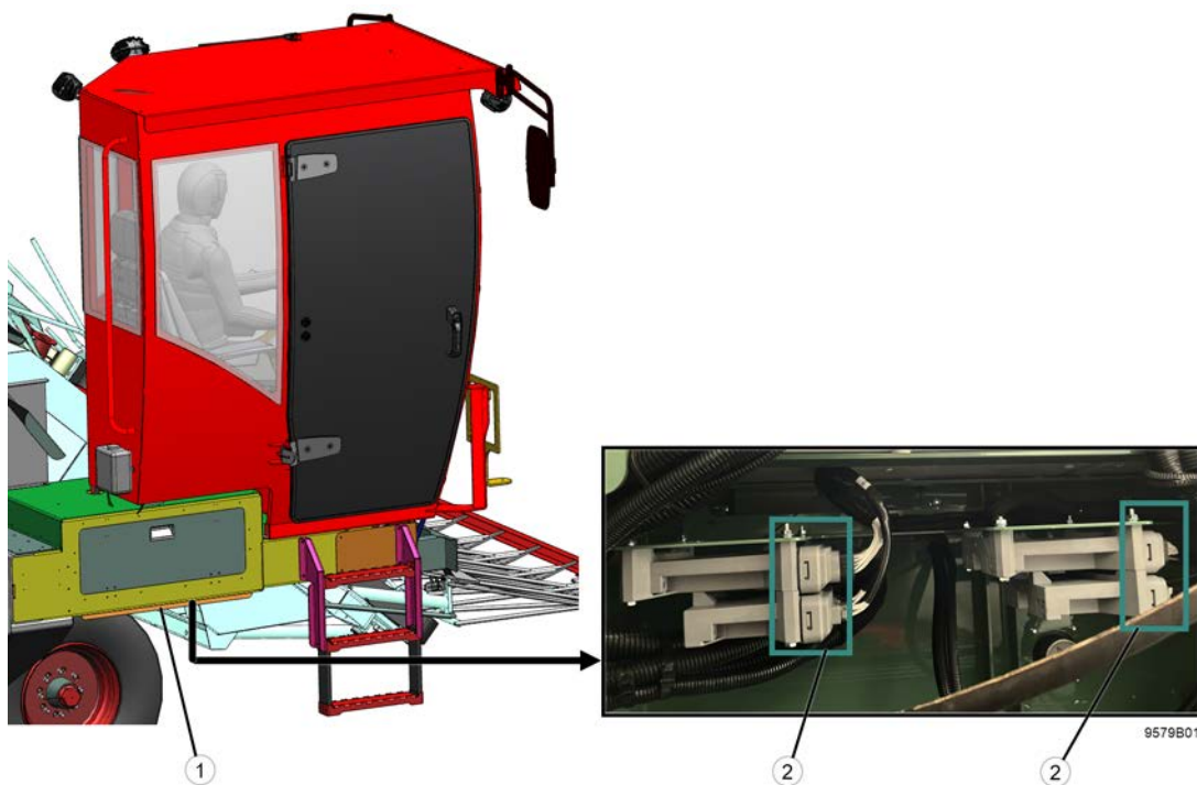
Fig. 162: Emplacement des contrôleurs
