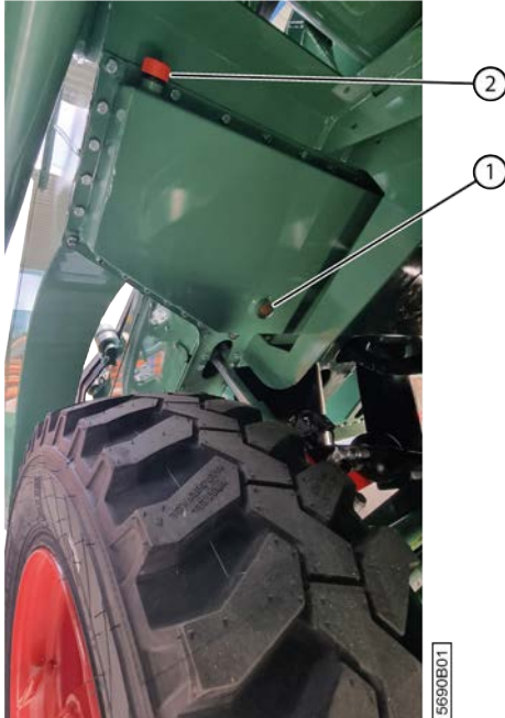
Fig. 143: Contrôle l'huile de l'engrenage de l'arracheur
