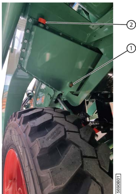
Fig. 144: Faire l'appoint d'huile de l'engrenage de l'arracheur
