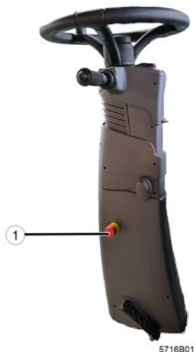
Fig. 47: Emplacement de l'arrêt d'urgence
