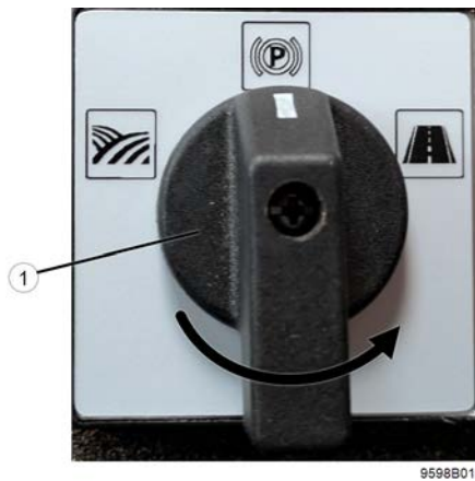
Fig. 81: Mettre l'interrupteur en mode Champs
