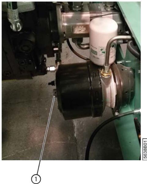
Fig. 157: Détacher le frein de parking
