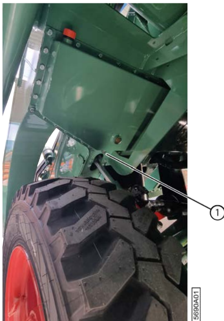
Fig. 145: Vider l'huile de l'engrenage de l'arracheur
