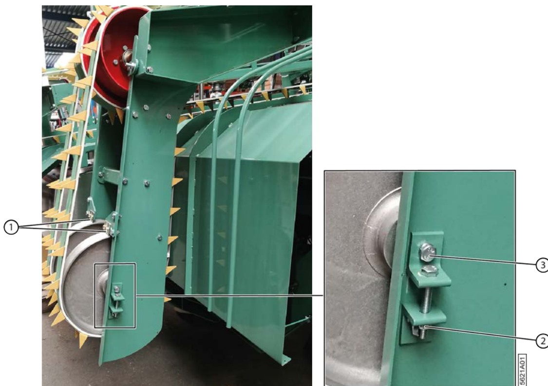
Fig. 100: Régler la tension des courroies déposées
